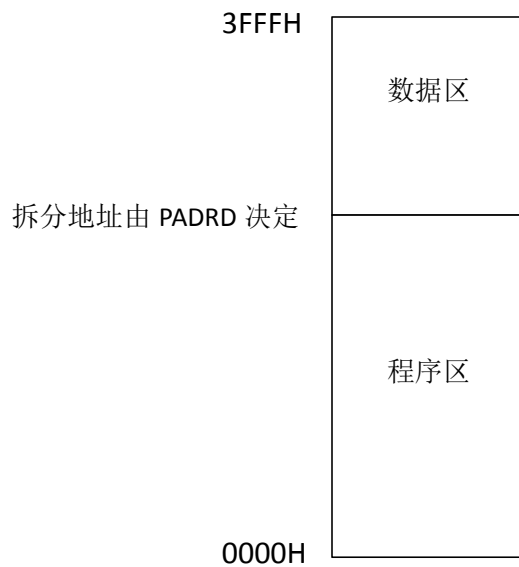
图 7-3-1 16K Flash 存储器结构
