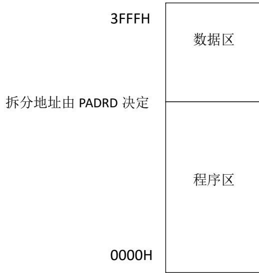
图 7-3-2-1 16K Flash 存储器结构
