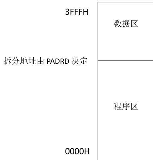
图 7-3-2-1 16K Flash 存储器结构
